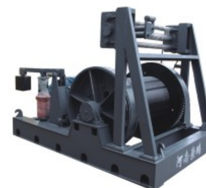
JK9吨快速卷扬机 绳速：30m/min 容绳量：650m
