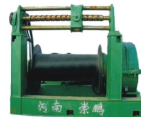
JK8吨电动快速卷扬机 用于MG80吨吊钩门式起重机主起升机构 (中国三峡总公司溪洛渡工程)
